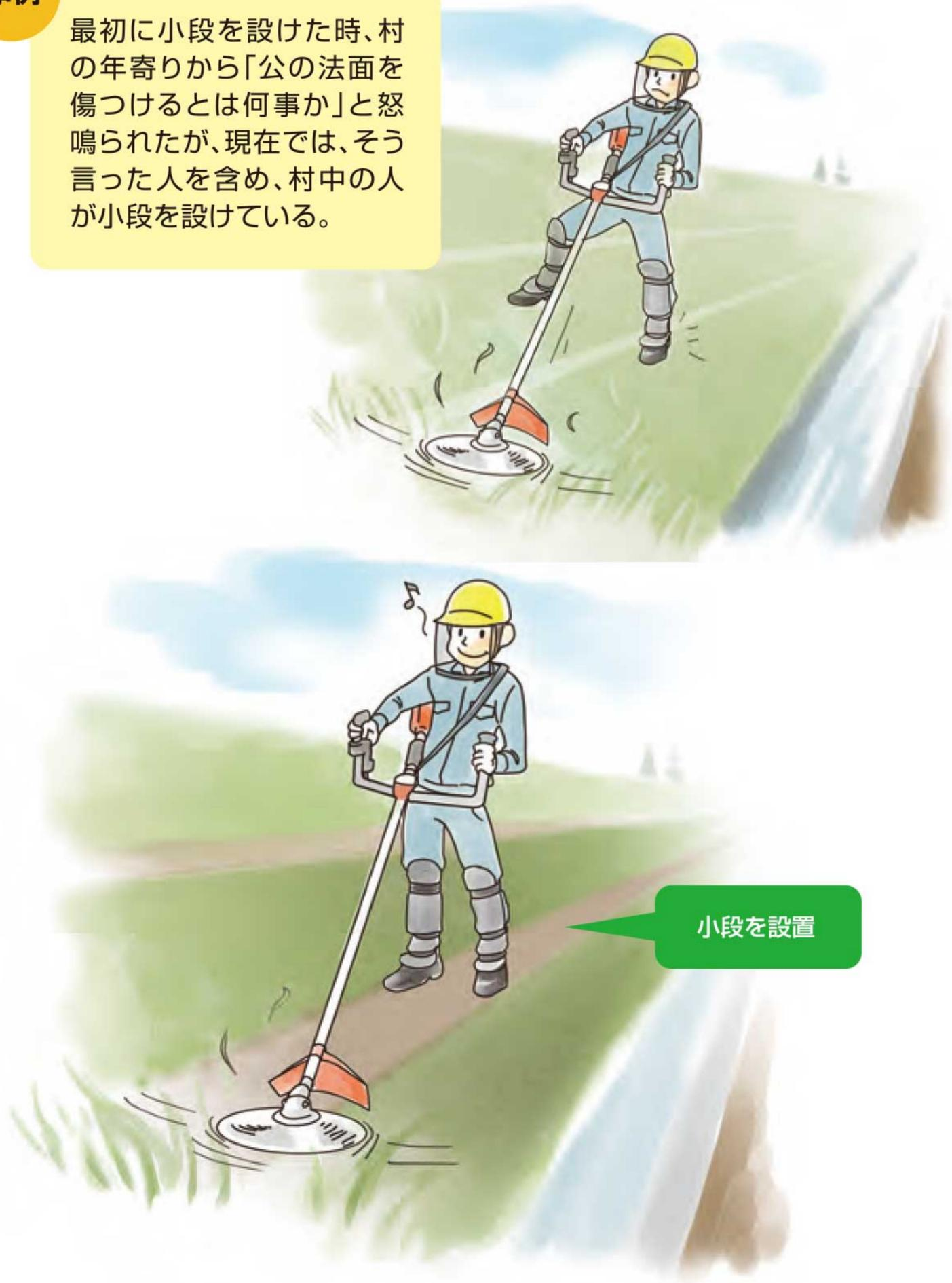
傾斜面・法面に小段の設置、スパイク靴の着用
